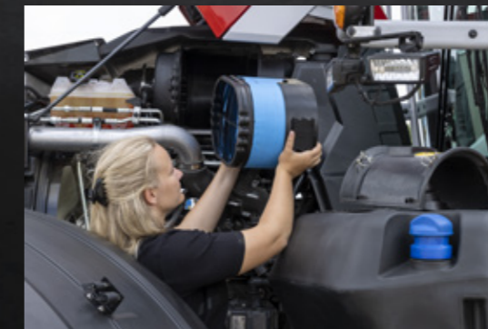
Het luchtfilter van de motor is goed bereikbaar en gemakkelijk te reinigen
