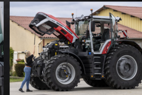
Dankzij de vooras en het slanke design van de motorkap zijn de oliepeilstok en het filter goed toegankelijk
