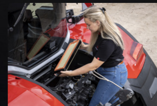
Cabineluchtfilter gemakkelijk bereikbaar om te reinigen
