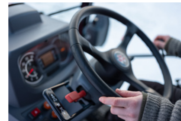
Mechanische transmissie met Power Shuttle op de MF 1700 M - 12Vx12A-versnellingen voor maximaal comfort bij iedere toepassing.
