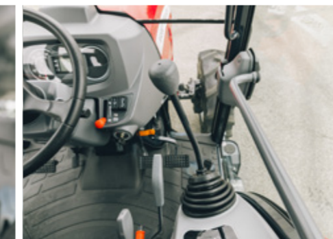
Meer comfort dankzij kantelbare stuurkolom en hydraulische joystick rechts voor makkelijke en nauwkeurige bediening van werktuigen
