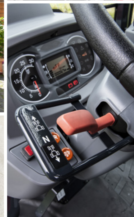
Elektrohydraulische omkeerhendel op MF 1700 M-modellen voor meer comfort
