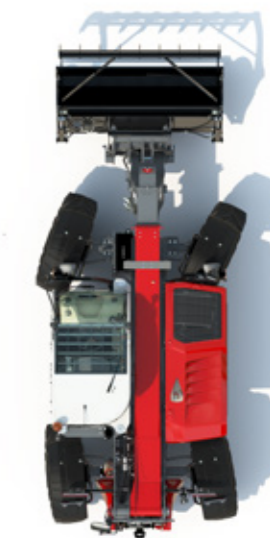
SEMI-HONDENGANGmodus vaste achterwielhoek – voor toepassingen zoals inkuilen of schuurreiniging.
