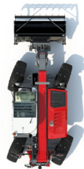
HONDENGANGmodus – voor efficiënt vullen en nivelleren en werken langs muren en in nauwe ruimten.
