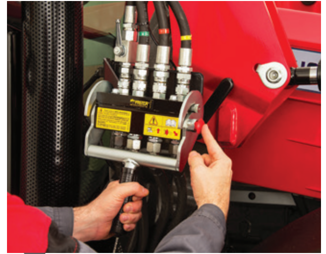
Verbreek de hydraulische en elektrische verbindingen
