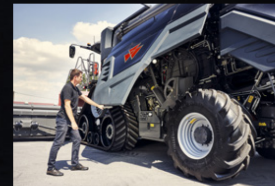
Zijpanelen uit één stuk met lampen bieden snelle en makkelijke toegang voor inspectie
