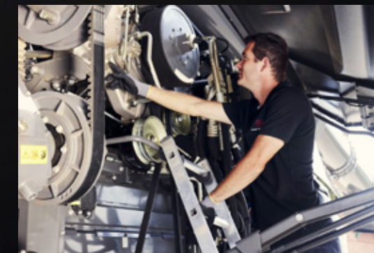
Vereenvoudigde aandrijflijnen met minder riemen en kettingen
