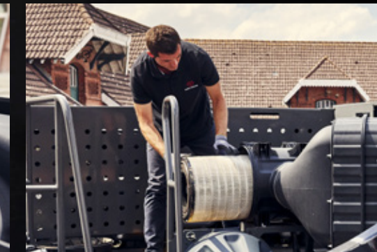
Makkelijke toegang voor controle en reiniging van het luchtfilter
