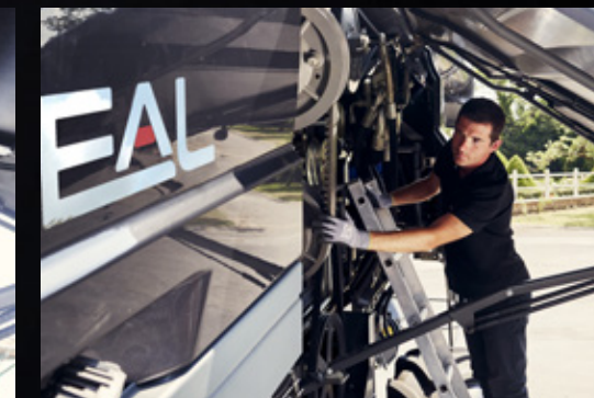
Draagbare ladder achter voor makkelijke toegang tot de hele machine
