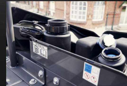
Makkelijk tanken - de vuldoppen voor diesel en AdBlue zitten naast elkaar voor makkelijke toegang
