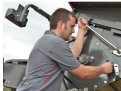
Gemakkelijke omschakeling van hakselen naar zwadafleg voor balen
