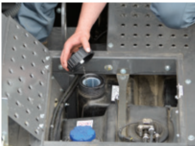
Eenvoudig tanken – beide tanks zijn naast elkaar geplaatst voor eenvoudige toegang
