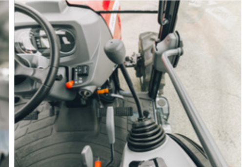
Plus de confort avec la colonne de direction inclinable et le joystick hydraulique côté droit pour un contrôle facile et précis des outils
