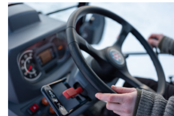
Transmission mécanique avec Power Shuttle sur les MF 1700 M - 12 vitesses avant et 12 vitesses arrière pour un maximum de confort pour chaque application.
