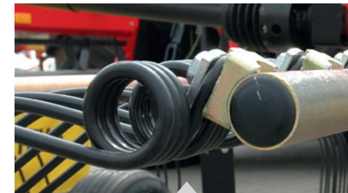
Partie avant parfaitement lisse du bras porte-dents
