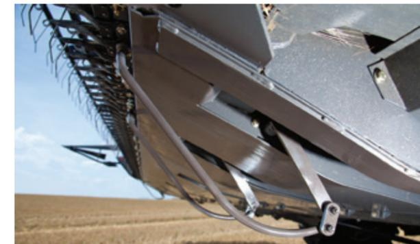
Le système AutoDevers contrôlant le suivi du relief du sol par la coupe est disponible en option. La transition fluide d'un côté à l'autre maintient une hauteur de coupe régulière et précise, grâce à l'action conjointe des performants circuits hydraulique et électronique.
